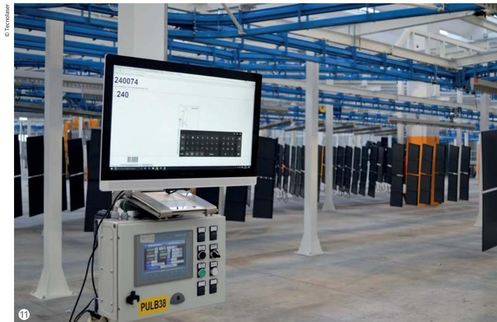
Figura 11: Il nuovo sistema di verniciatura è gestito da un *software* 4.0 integrato.
