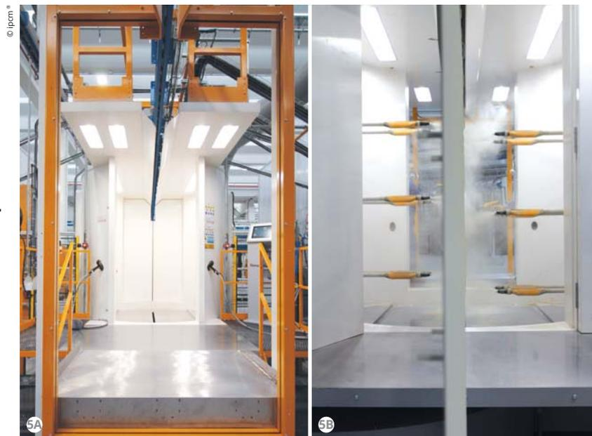
**Figure 5A e 5B: La nuova cabina di verniciatura a cambio colore rapido MagicCylinder di Gema.**
