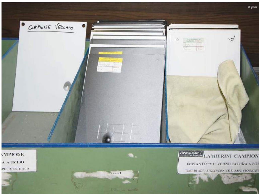
Alcuni lamierini sottoposti a prove di adesione.
