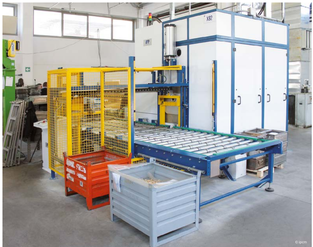
Il movimentatore per trasportare le ceste con le minuterie nelle macchine di lavaggio e le macchine di lavaggio di IFP Europe.
