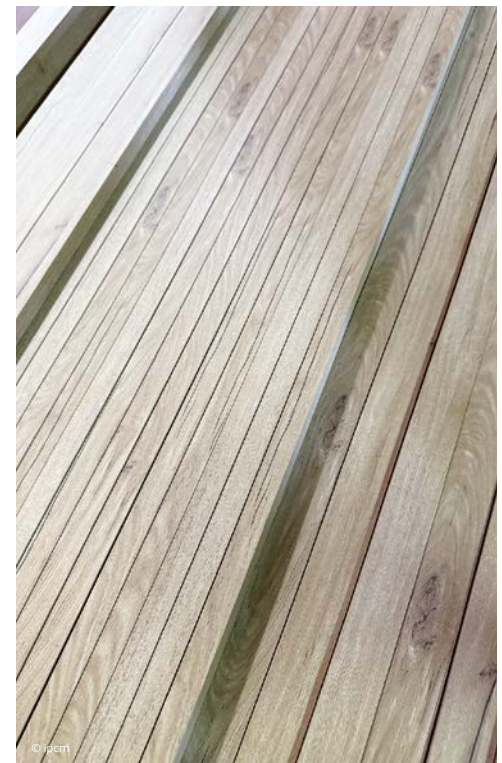
Perfil con recubrimiento base en polvo antes de la sublimación (arriba) y perfil sublimado con efecto madera.
