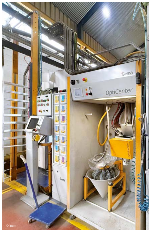
Fase de aplicación de los productos de recubrimiento, la cabina OptiCenter de Gema y la entrada de los perfiles en el horno de polimerización. A aplicação dos produtos de pintura, cabine OptiCenter, da Gema e entrada dos perfis no forno de polimerização.
