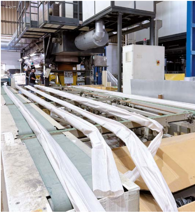
Los operarios aplican a mano la película decorativa, controlando su correcta adhesión a lo largo de toda la superficie de la pieza.
