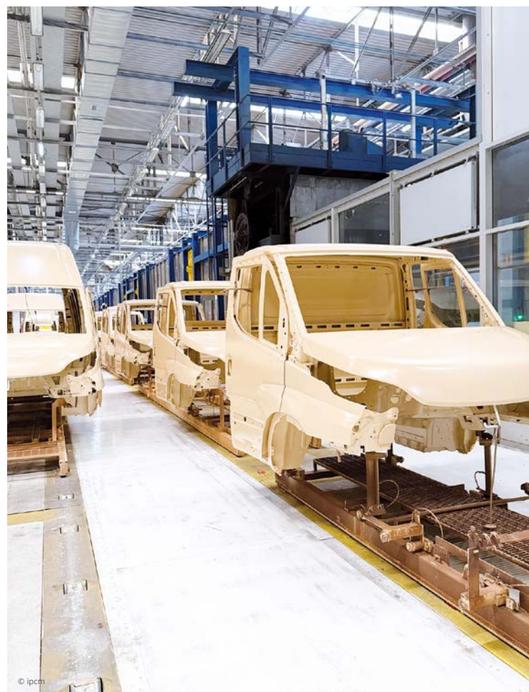
Tras la cataforesis, los componentes se someten a una fase de enfriamiento antes del recubrimiento. Após a cataforese, os componentes passam por uma fase de resfriamento, antes da pintura.
