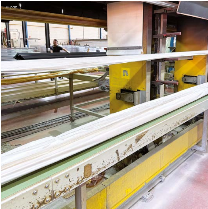
El vacío permite que la película se adhiera de manera uniforme al recubrimiento base en polvo.
