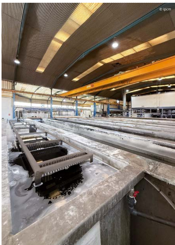
Vista general del ciclo de pretratamiento por inmersión y la línea de lacado horizontal de Lacalum.
