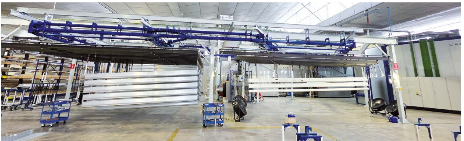
C3 Systems se ha dotado de un moderno departamento de recubrimiento superficial en polvo de los perfiles en aluminio suministrado por Cabycal (Alaquàs, Valencia).
