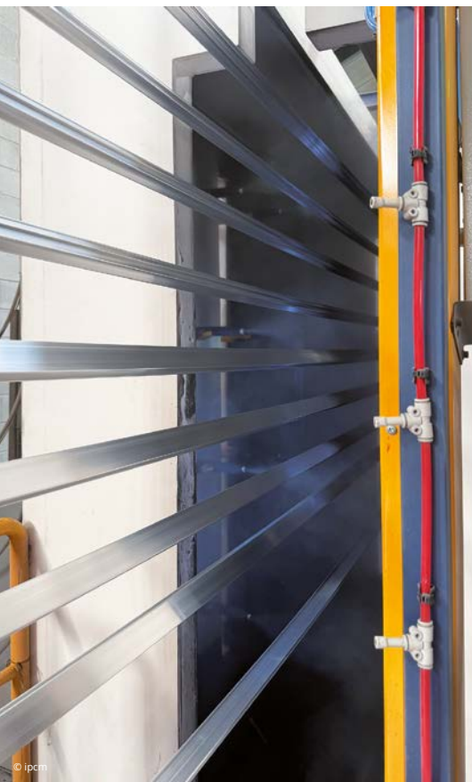
Fase de aplicación de los productos de recubrimiento, la cabina OptiCenter de Gema y la entrada de los perfiles en el horno de polimerización. A aplicação dos produtos de pintura, cabine OptiCenter, da Gema e entrada dos perfis no forno de polimerização.
