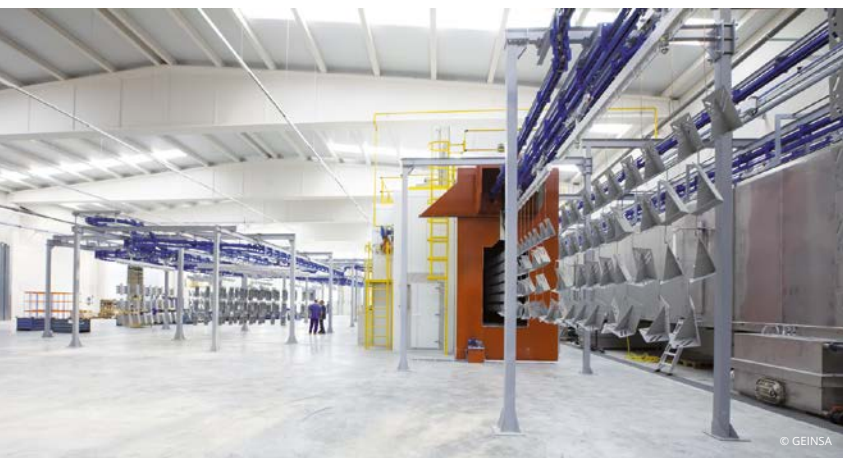
Línea automatizada de pintura en polvo (izquierda) y cabinas de pintura para el sector eólico.
