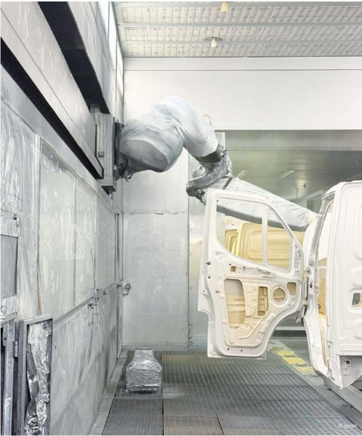
La carrocería dentro de la cabina robotizada de recubrimiento superficial. A carroceria dentro da cabine de pintura robotizada.
