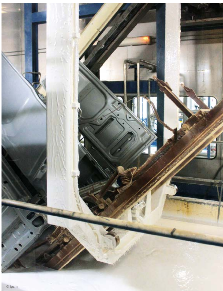
La entrada de una carrocería en la cuba de cataforesis. Uma carroceria entrando no tanque de cataforese.
