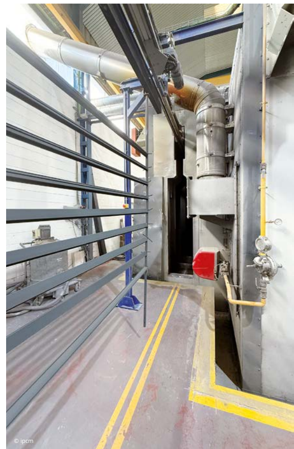
Fase de aplicación de los productos de recubrimiento, la cabina OptiCenter de Gema y la entrada de los perfiles en el horno de polimerización. A aplicação dos produtos de pintura, cabine OptiCenter, da Gema e entrada dos perfis no forno de polimerização.
