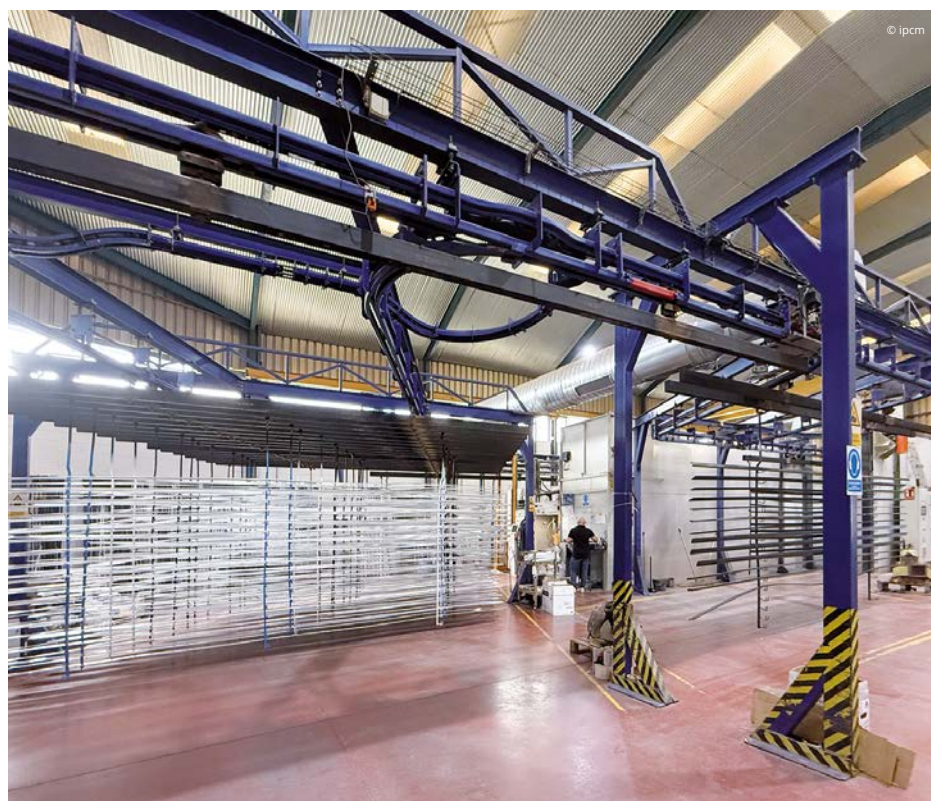
Vista general del ciclo de pretratamiento por inmersión y la línea de lacado horizontal de Lacalum.
